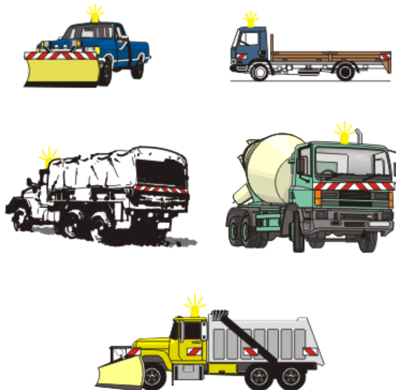
Joonis 41. Sõiduki tähistamise näited liikuva iseloomuga töödel
