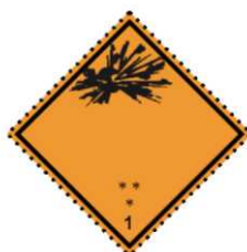
(Nr 1) Jaod 1.1, 1.2 ja 1.3 Sümbol (plahvatav pomm): must; Taust: oranž; Arv „1” all nurgas
