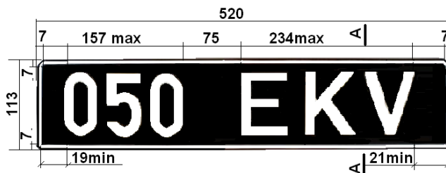
Auto üldkasutatava registreerimismärgi mõõdud ja väljad
