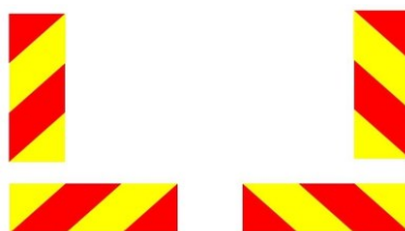
Joonis 4. N3 kategooria sõiduki tunnusmärk a, b, c ja d on näited tunnusmärkide paigaldusest N3 kategooria sõiduki, välja arvatud sadulveduk, tagaosale.
