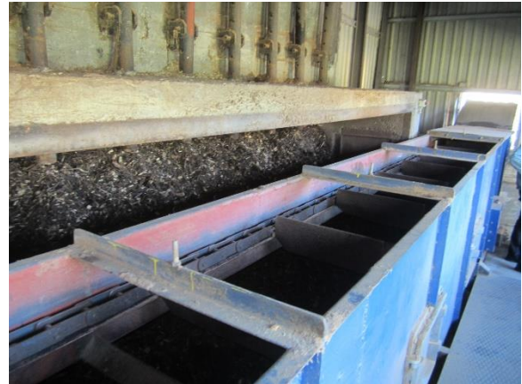
Joonis 2.7. Vabriku katlamaja hakkepuidu ladu ja transportöör
